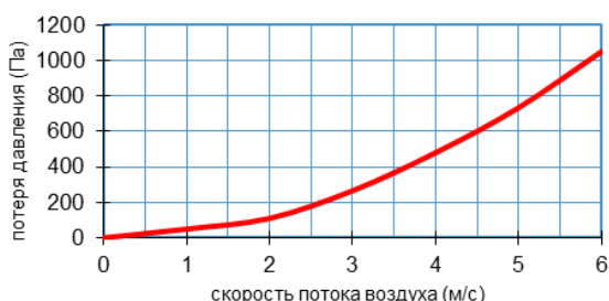
Угол поворота лопаток 30° (все типоразмеры заслонок)
