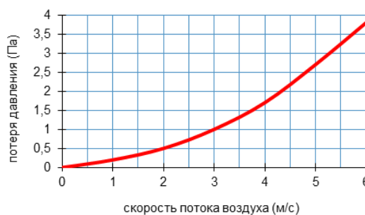
Угол поворота лопаток 90° (VZL 40-20, VZL 50-30, VZL 60-30, VZL 70-40, VZL 80-50, VZL 90-50, VZL 100-50)
