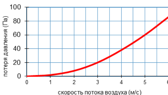
Угол поворота лопаток 60° (VZL 40-20, VZL 50-30, VZL 60-30, VZL 70-40, VZL 80-50, VZL 90-50, VZL 100-50)
